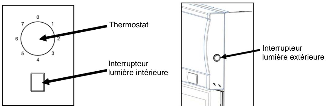
La première fois que vous mettez votre appareil en fonctionnement, mettez le thermostat sur la position intermédiaire « 4 » et laissez-le fonctionner à vide durant 4 heures avant d'y entreposer des boissons afin qu'il soit suffisamment refroidi.
